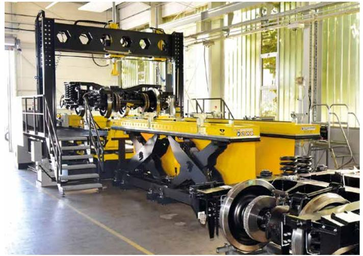
Links: Ein Highlight der Robel-Leistungsschau war die neue 8-Spindel-Schraubmaschine, die in einer Stunde 750 Verschraubungen an Schwellen schafft. Rechts: Neu ist auch der Drehgestellprüfstand für Radsätze und Drehgestelle aller gängigen Spurweiten.
